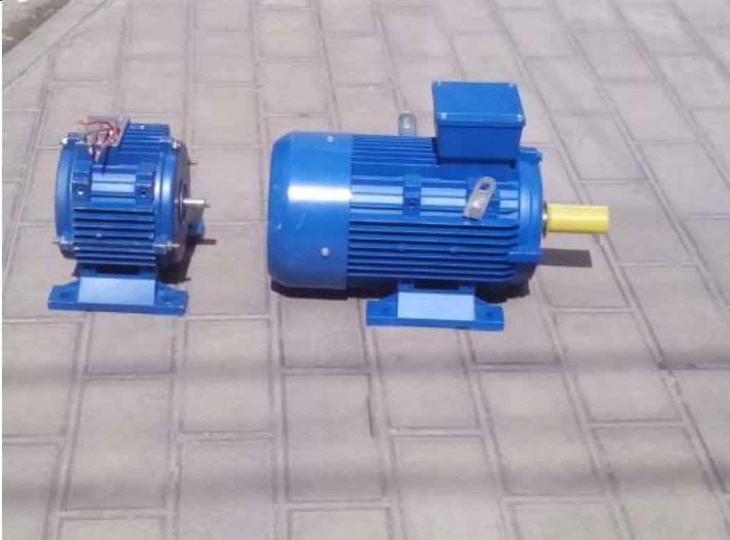
АИР -112 ელექტროძრავა (მარჯვნივ) და მის ბაზაზე დამუშავებული (დამოკლებული) იმავე სიმძლავრის მაღალსიხშირული ელექტროძრავა
